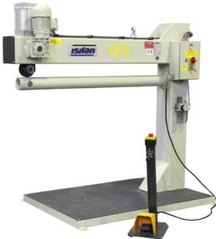
Создан в соответствии с директивами ЕС по безопасности и имеет маркировку CE. Система зажима с приводом от коробки передач. Простое управление с помощью пневматического прижимного поршня.
