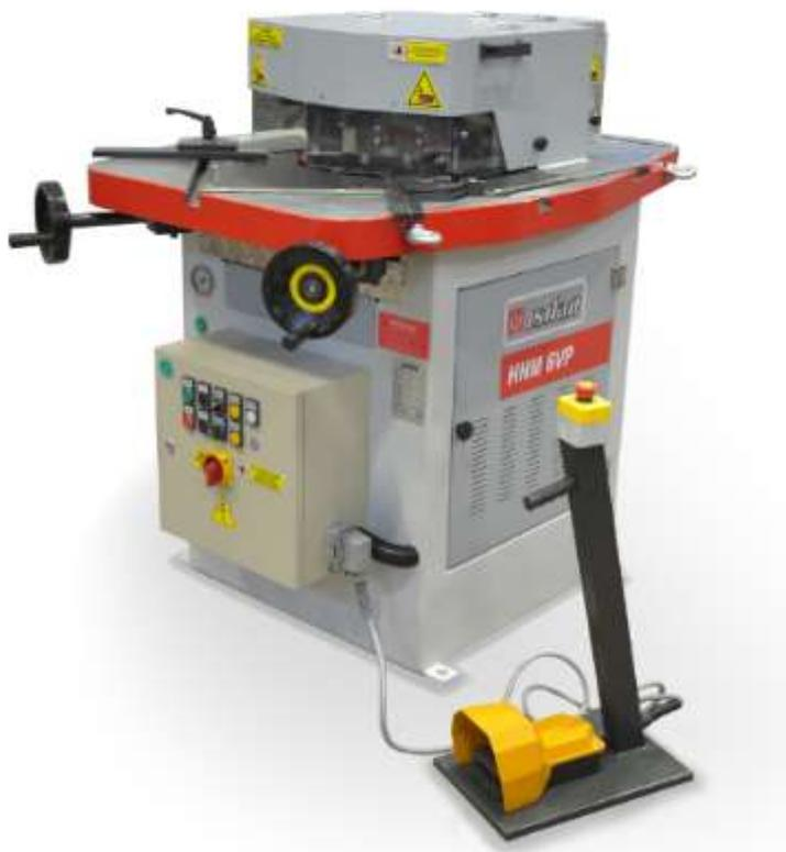
Созданные в соответствии с директивами ЕС по безопасности и имеющие маркировку CE ННМ-6 V-образные гидравлические угловые вырубные станки с переменным передним углом имеют прочную раму со статически и динамически жестким стальным столом и материалом верхней балки. выравнивание листов разной толщины с помощью автоматической регулировки зазора между ножами.
