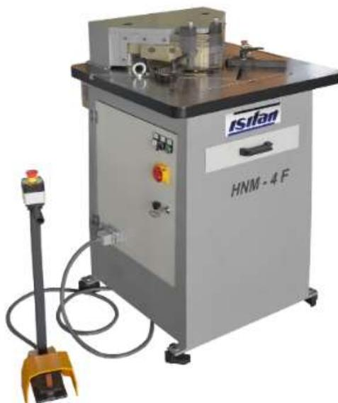
Созданный в соответствии с директивами ЕС по безопасности и имеющий маркировку CE, верхний стол с Т-образным пазом обеспечивает точную резку и отсутствие необходимости выравнивания для листов разной толщины с помощью автоматической регулировки зазора между лезвиями. -нижние цилиндры.
